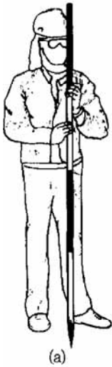
Figure 22 : Positionner une perche de coin verticalement (a) à l'aide d'un fil à plomb (b) ou d'un niveau (c).
