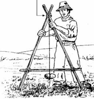
Figure 53 : Construction d'un niveau de charpentier traditionnel également appelé cadre A.
